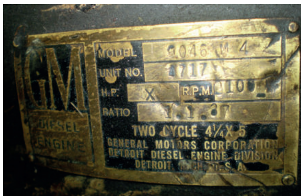
4. kép: A meghajtómotor adattáblája
