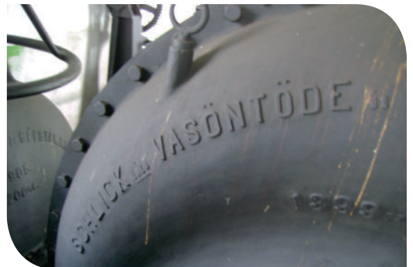
1. kép: A Schlick-szivattyú csigaháza, amelyben a járókerék percnként 124 fordulatot tesz meg
