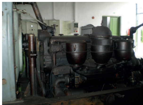
8. kép: Levegőszűrő, roots fúvó és adagoló rendszer a motor külső oldalán
