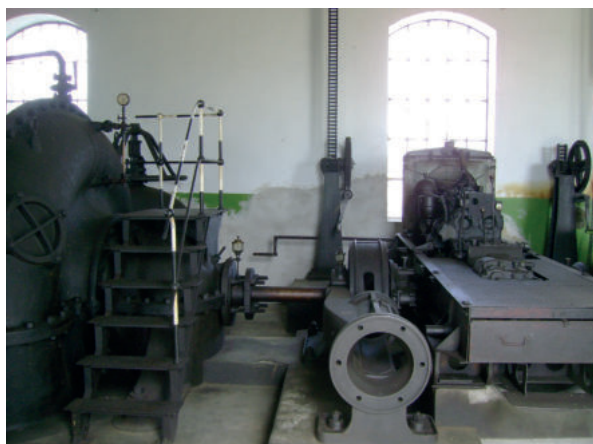
7. kép: A motor erőgép és erőátviteli rendszere
